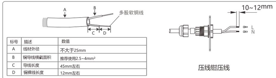
注意: 连接交流电力线前, 请确保SCB3000前级开关处于断开状态。
